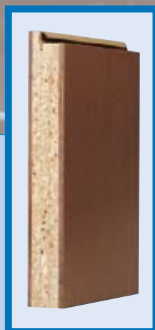
ES2, Türdicke ca. 42 mm, mehrlagige Vollspaneinlage, dreiseitige Türfalzdichtung, SSK2, RwR = 34 dB
