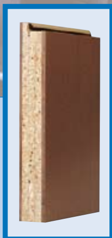
EV1, Türdicke ca. 42 mm, Vollspaneinlage, dreiseitige Türfalzdichtung, SSK1, RwR = 27 dB
