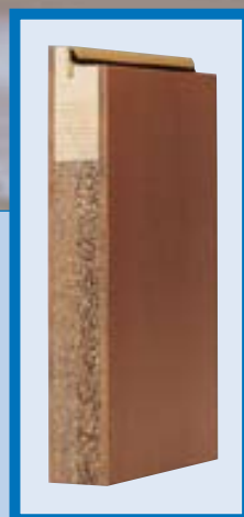
EG3, Türdicke ca. 48 mm, spezielle Schalldämmeinlage, dreiseitige Türfalzdichtung, SSK3, RwR = 37 dB
